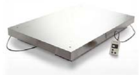
図1 鹿屋体育大学スポーツパフォーマンス研究センターにおける撮影装置と1mサイズのフォースプレート
