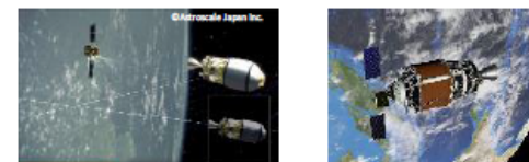
フェーズⅠ 非協力的ターゲットへのランデブ、近傍制御、映像の取得 フェーズⅡ 左記に加え、捕獲・除去
