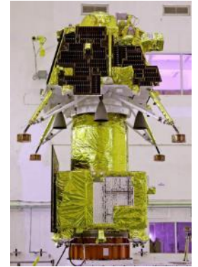
推進モジュール 2,148kg (写真は着陸機モジュールを 上部に搭載した状態)
