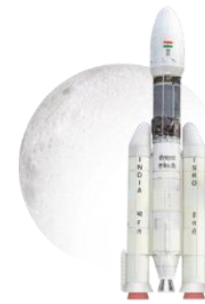
LVM3ロケット (GSLV Mk-IIIロケット) 全長43.43m, GTO軌道へ 4ton級打上能力
