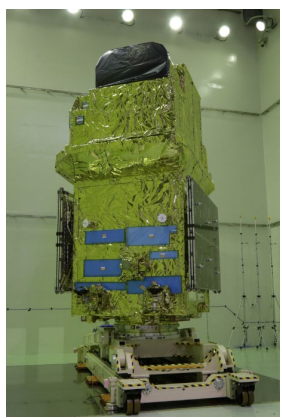
システム擾乱試験 (試験後の組立の様子)
