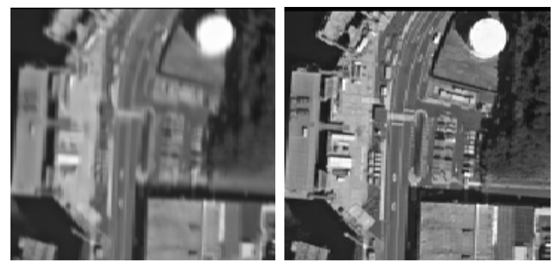
振動アイソレータ無 振動アイソレータ有 分解能0.8m相当の元画像に対して、システム擾乱試験で取得した擾乱の影響を反映したシミュレーション画像 振動アイソレータによる擾乱低減効果予測
