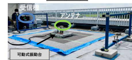
屋外地震座布団実験（建築研究所本館屋上） （アンテナ、受信機の比較実験）
