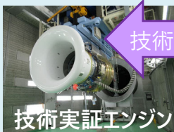
図2 軽量吸音ライナの構造健全性技術実証
