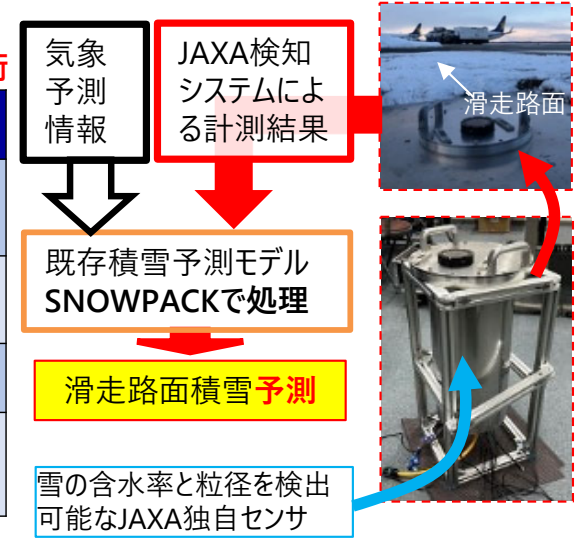
図2 JAXA埋設型雪氷検知センサを活用した予測
