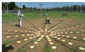
図1 成田空港でのマイクロホンアレイによる音源測定の様子
