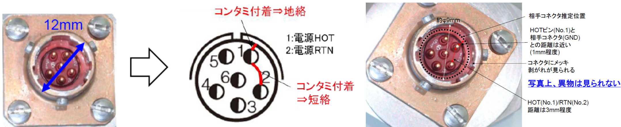
コネクタ構造とコンタミ付着による短絡・地絡のイメージ
