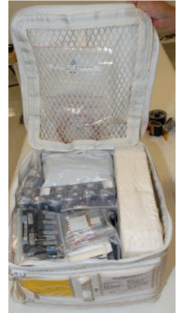
GRABミッション ISSで使われているカーゴ輸送 バッグ(CTB)に類似したGRAB を使う。電気や通信IFはない。 ※GRAB: Gateway Research Accommodations Bag
