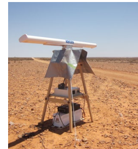
図3 追跡に供した固体化マリンレーダー
