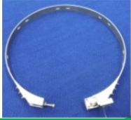
図1 火工品小型衛星分離機構(マルマンクランプバンド型)→
