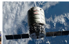
「こうのとりのり」で開発したランデブ・キャプチャー技術を採用した、シグナス補給船運用1号機
