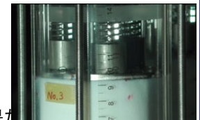
粉化対策の振動試験の様子
