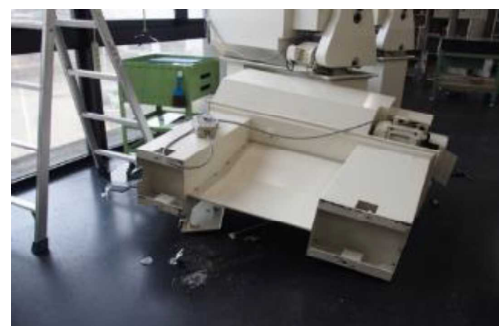
令和3年福島県沖地震により小型精密旋盤が転倒し破損
