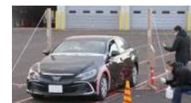
車両ゲート型放射線モニターの検証試験
