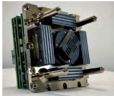
図 Altius社が開発した磁気ラッチコネクタ（MagTag） [3]
