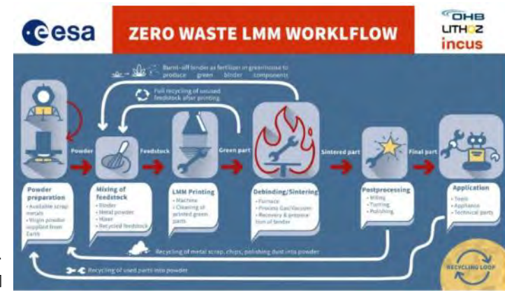
図 Zero Wasteを実現するLMMワークフロー [3]
