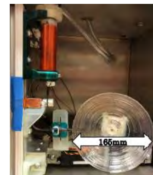
図 アンテナ反射鏡製造3Dプリンター [1]
