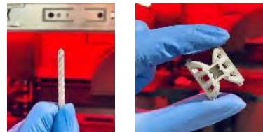
図 リサイクルされたチタン粉末からLMM技術で製造されたパーツ [1]
