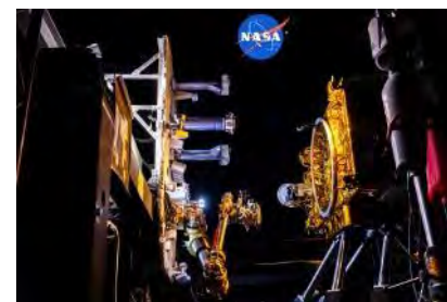
図2 OSAM-1のロボットアームによる自動捕捉テスト [6]
