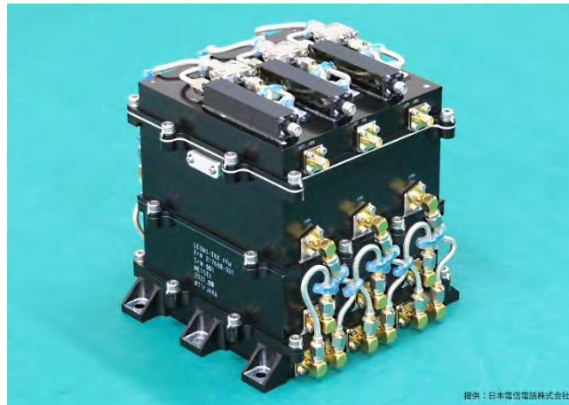
図表 25 低軌道衛星 MIMO/IoT 伝送装置 LEOMI
