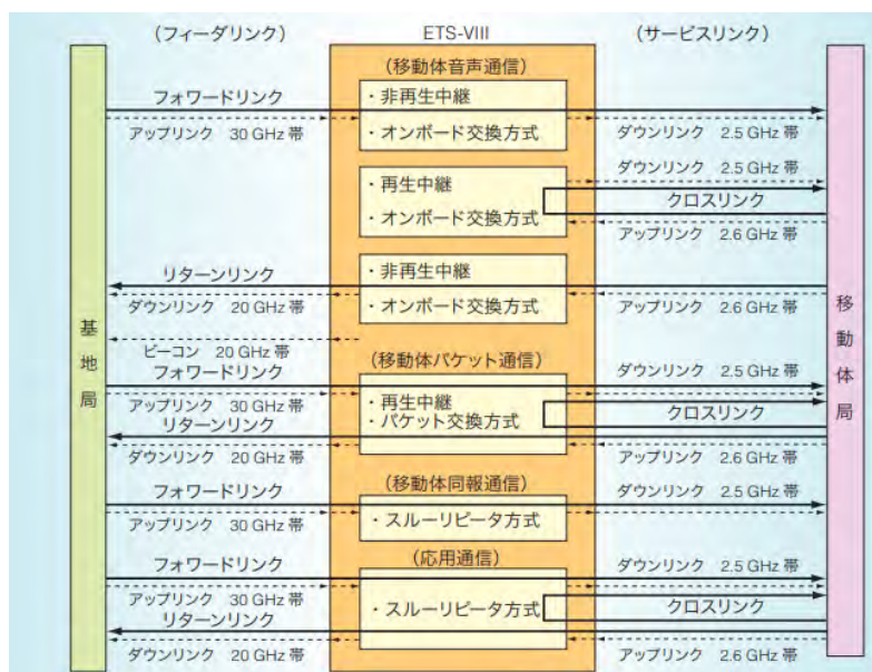
図表 126 ETS-8による移動体通信試験の回線構成
