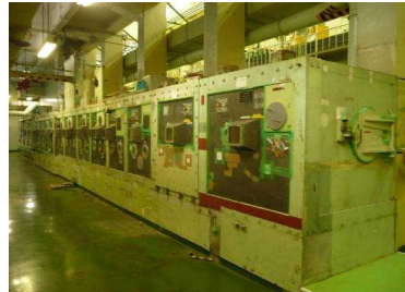
厚い遮蔽材で構成されている鉛セル
