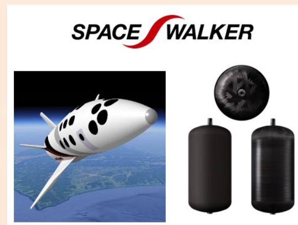
図: サブオービタルスペースプレーンの機体イメージ(左)と複合材タンクの外観(右)
