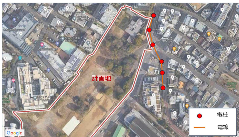
図 2-12 電力・通信の計画地周辺の敷設状況
