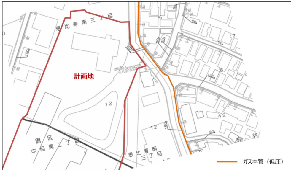
図 2-11 東京ガス ガス導管図
