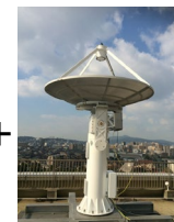
複数の大学の数m級アンテナを時間同期させて運用
