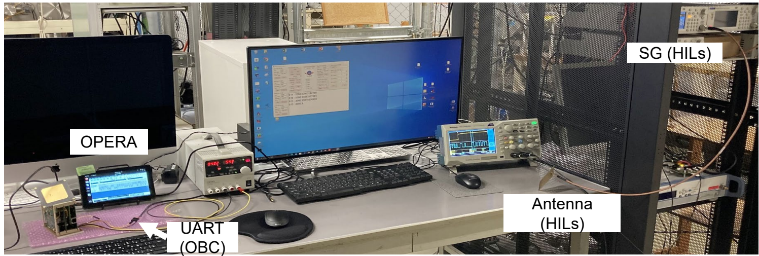
OPERA FMのHIL試験シミュレータを用いた機能試験
