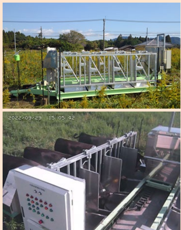
図9. 個体識別遠隔自動給餌機 全貌(上図)とウシを捕獲した時の様子(下図).
