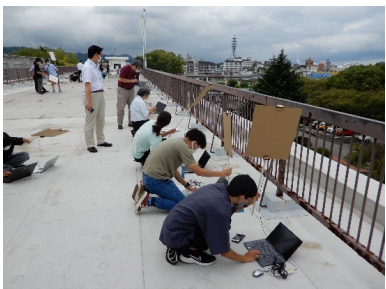
高専スペースキャンプの対面実施 (R3年度) で行った段ボール八木アンテナ製作とKOSEN-1のCW受信実験
