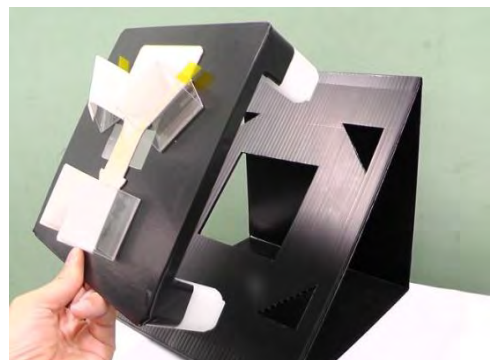
<写真5> 製品の形状ごとで取り換え可能な方式
