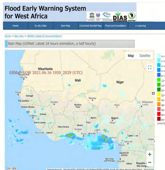
洪水早期警報システム(FEWS)でのGSMaPによるリアルタイム降雨分布(左)と洪水危険地点での想定最大浸水深(右)
