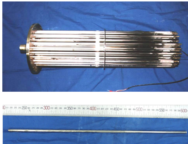
工学規模試験における鑄造後の鑄型の外観とU-Zr合金スラグ
