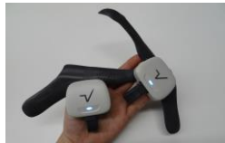
靴に取り付け、振動で方向を知らせる機器
