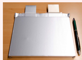
(左上) 正極材料(NCM811)、(左下) バインダーフリー導電助剤を搭載したラミネル電池、 (右) カーボンナノチューブを用いたバインダーフリー導電助剤
