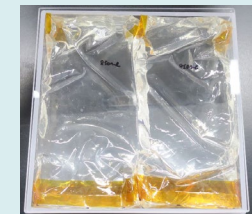
放射線保護容器の上部/下部のポリカ製ブロック(水バッグ収納状態)
