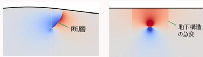
図：本手法による地殻変動の解析結果 図は地下構造の断面図、配色は地震による地殻の変形の計算結果を表す。断層や地形の連続的に曲がった形状や、断層や地下構造の急激な変化によるひずみが解析できている。
