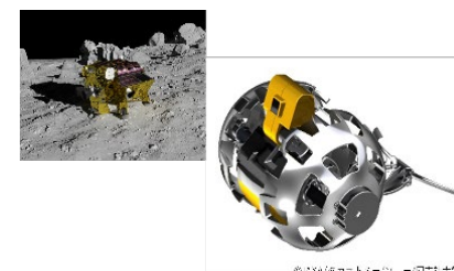
SLIMに搭載した変形型月面ロボット SORA-Q (宇宙探査イノベーションハブ研究の一例)
