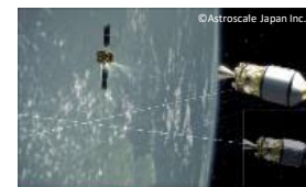
フェーズⅠ 非協力的ターゲットへのランデブ、近傍制御、映像の取得
