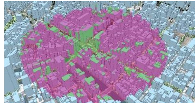
5G/Beyond5Gにおける電波伝搬シミュレーションによる置局設計・運用 衛星測位電波シミュレーション予測によるモビリティの最適運用
