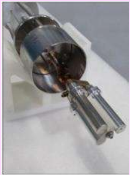
試料環境の高度化 非弾性散乱測定用リポル バー式自動試料交換機
