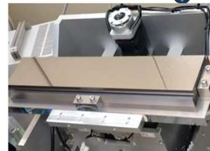
薄膜の面内構造を調べるために斜入射中性子小角散乱(GISANS)が必要。現行のゲイン5倍の集光では十分ではないため、新しい集光ミラーを作り実装。
