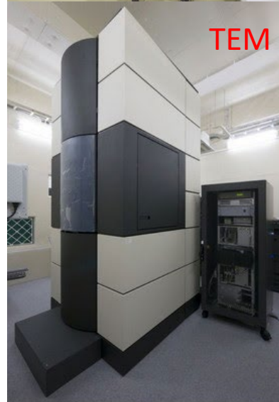
FEI Titan Krios CryoTEM 300 kV
