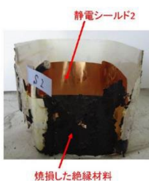
図8 (左) トランス (同型品) の内部、(右) 焼損した絶縁材料
