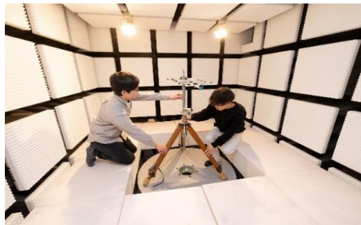
図3 光電磁環境研究 (電波暗室)
