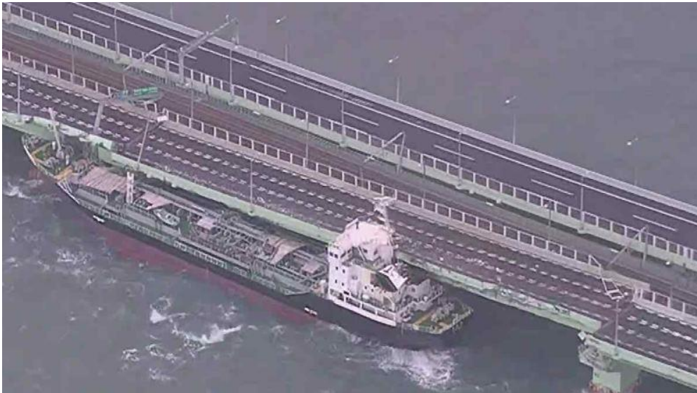
大阪府泉佐野市 関西国際空港ではタンカーが走錨して連絡橋に衝突した （画像：国土交通省）
