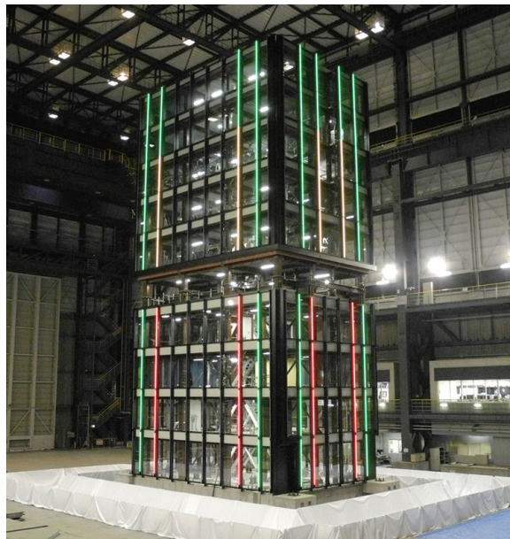
建物の事前の地震対策と地震後の損傷評価に資する技術を検証開発するため、令和5年2月に実施した10階建て鉄骨造オフィスビルのEーディフェンス震動台実験の様子 （写真提供：防災科学技術研究所（NIED））
