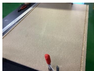
図2 溝掘り ルーターを用いて一枚の大きな板に溝を作り、組み立て時のズレを防ぐ。
