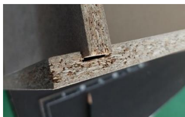
図3 組み立て 凹凸を合わせ接合。
