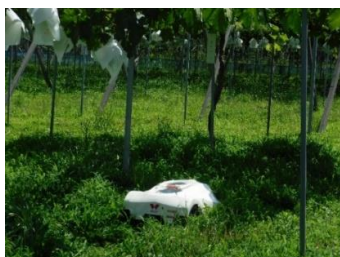
図7 ロボット除草機の導入 果樹の省力化を目的に、ロボット除草機を導入した。周囲に埋めた電線内のみの除草になるが、昼夜休みなく草刈りをする。
