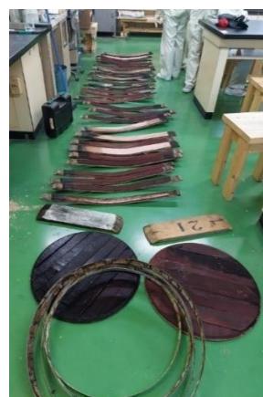
図1 樽の構造を知る 樽を解体し、どのように作られているのか確認した。
