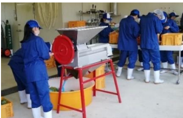
図2 除梗破碎作業
