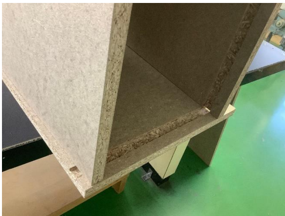
図3 溝に板をはめ込み接合する様子
