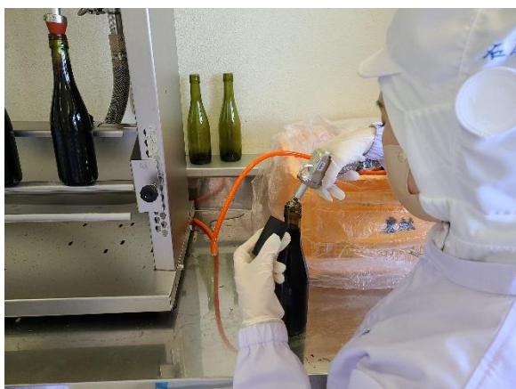
図4 ワインボトルの液面上に生じるヘッドスペースを窒素ガスで置換する作業
