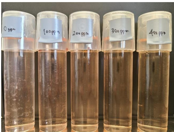
図7 ベントナイト添加量別の試験結果
