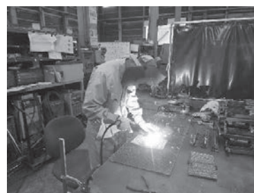
半自動溶接実習
