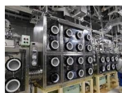
MOX燃料製造 グローブボックス
