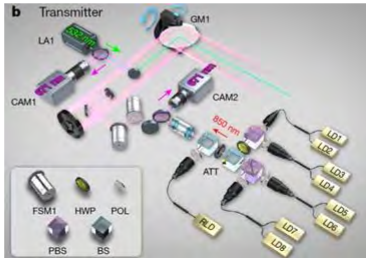
BB84 プロトコル用送信器（波長850 nm）
