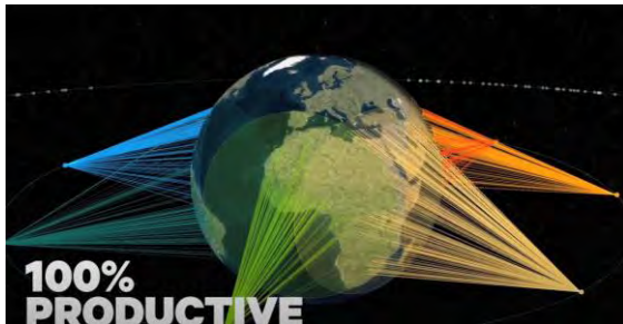
古典的なフィードホーンを用いた4色の周波数再利用スキームを用いた典型的なマルチスポットKa-Band HTS。これは、SFPBを用いたSDMAの一種です。[出典: Eutelsat]
