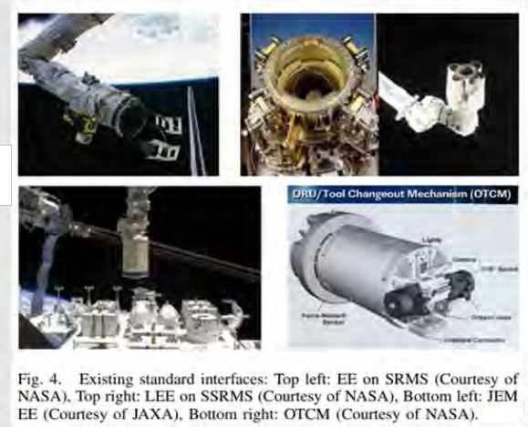
ISSで使用されているロボットアームのエンドエフェクターにおける標準化の例 (2)
