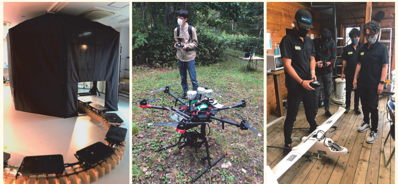
全照射角度・計測角度に対する全自動スペクトル計測システム（左）。ライダーと分光器を搭載したドローン（中央）。ビジネス運用を目的とした垂直離着陸機（右）。
