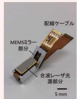
超小型光学エンジンの試作品（従来との体積比 1/100 以下）
