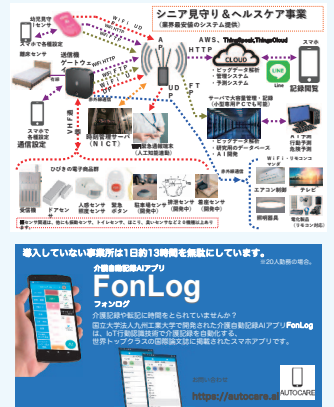
PJ1 で開発した各種センサと介護自動記録 AI アプリ
