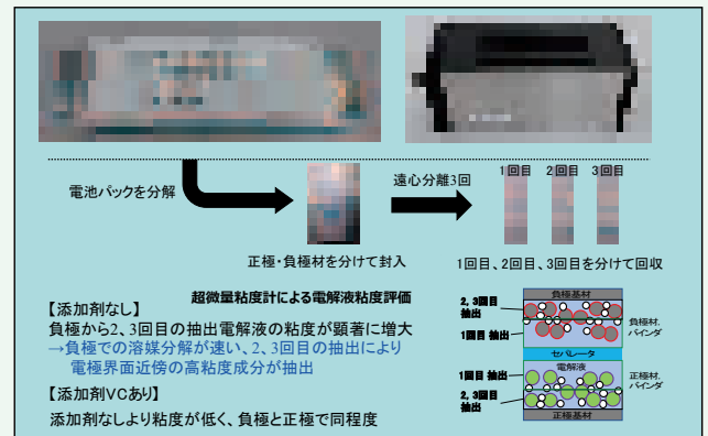
上段左：Mn系Liイオン電池、上段右：電池モジュール、 下段：超微量粘度計による電解液粘度評価
