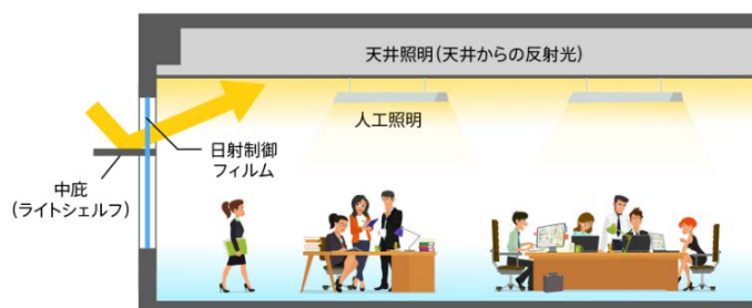
図 13 自然採光手法の例（ライトシェルフ） （出所）環境省ホームページ 「ZEB PORTAL（ゼブ・ポータル）」
