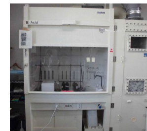
ドラフトチャンバー内の有機合成等で発生するガス等を排出
