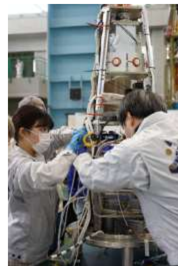
観測ロケット噛み合わせ 試験(担当機器の計装)
