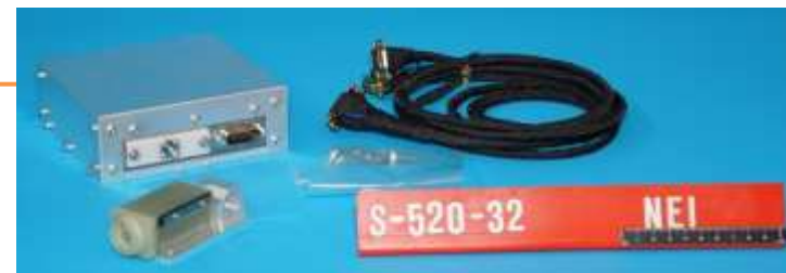
NEI-S(センサー), NEI-E(電子回路部), ハーネス
