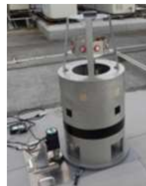
観測ロケットの回転モックアップを使ったアンテナシステム試験
