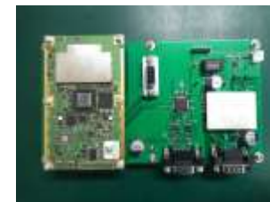
GNSS基板パターン(左)と完成品(右)
